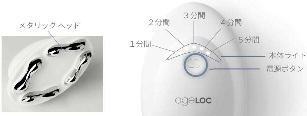
「電源ボタンを押しているのに時間が変わらない」ときは、メタリックヘッド部分に触れていないかチェック（肌が触れると本体がお手入れ中と判断してしまい、お手入れ途中での時間変更を受け付けないため）。
